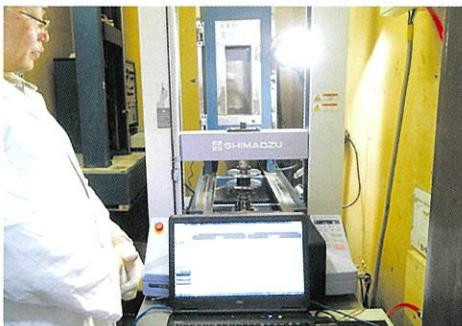
50%圧縮応力測定試験
